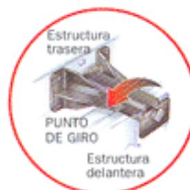
El TWISTER tiene una Suspensión Activa "en chasis" que aumenta la tracción y le proporciona una conducción suave y flexible en terrenos accidentados.
