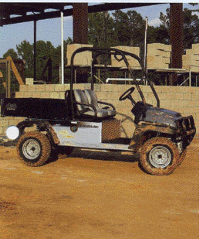
La superficie de carga es de 0,432 m<sup>2</sup>, y la capacidad de carga del vehículo es de ¡544 kg!
